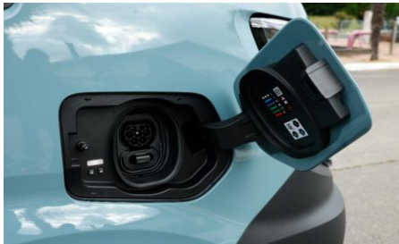
Ladduttag framför passagerardörren
