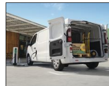
Generös lastvolym (6,7 m 3 ) och lastlängd med genomlastningslucka (4150mm) Möjlighet att få full tillgång med skjutdörr på vänster sida
